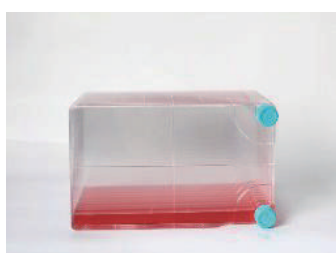
2、セルファクトリーを横にして液面のバランスを整える。
